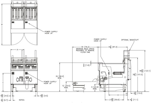
440V AND 480V UNITS REQUIRE SEPARATE SINGLE PHASE (115V-240V) POWER SUPPLY FOR PUMP AND BASKET LIFT OPERATION.
